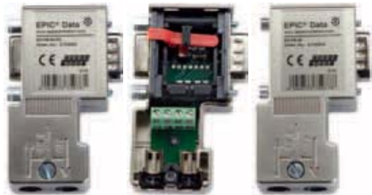
EPIC® Data PROFIBUS штекерный соединитель 90°, винтовое соедин.
